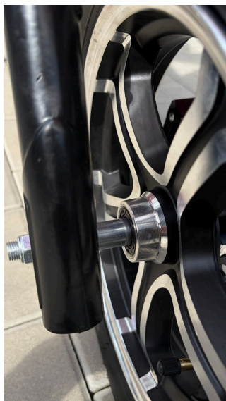
Náboj předního kola s osou a uložením v ložiscích.
