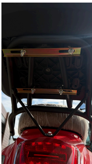
Úložný box přišroubovaný k zadnímu nosiči — pohled zespodu na montážní lišty.
