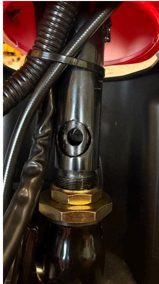
Sloupek řídítek se stahovacím šroubem — pohled na otvor, kterým prochází upínací šroub.
