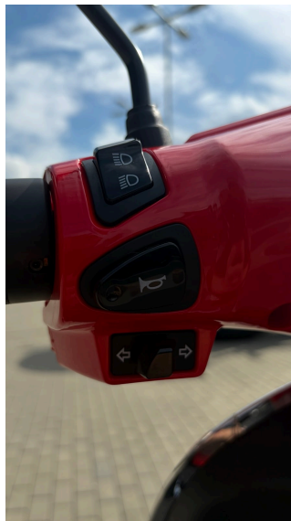
Levá strana řídítek — houkačka, blinkry, přepínač světel.
