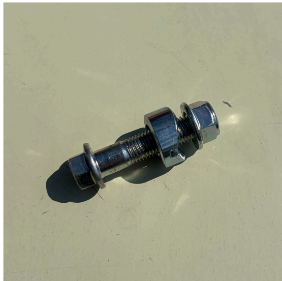
Šroub s podložkami, matkou a distanční rozpěrkou — kompletní sestava pro upnutí řídítek.
