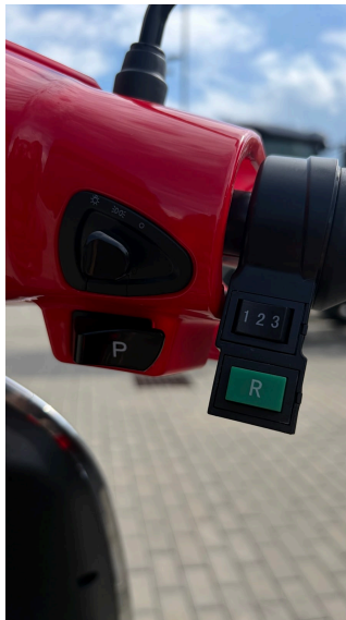
Pravá strana řídítek — světlá, parkovací brzda, rychlostní stupně, zpátečka, plyn.
